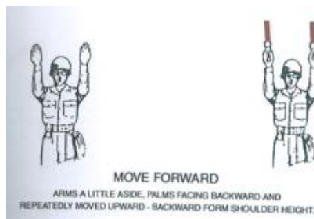
ภาพที่ ๖.๑๘ การให้สัญญาณแก่ Helicopter เพื่อให้เครื่องบินเคลื่อนที่มาข้างหน้า (MOVE FORWARD)
