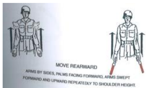
ภาพที่ ๖.๑๙ การให้สัญญาณแก่ Helicopter เพื่อให้เครื่องบินเคลื่อนที่ไปข้างหลัง (MOVE REARWARD)
