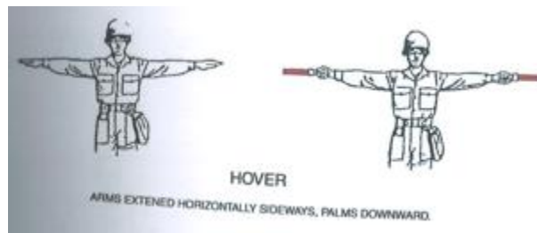
ภาพที่ ๖.๑๗ การให้สัญญาณแก่ Helicopter เพื่อให้เครื่องบินออยตัวอยู่กับที่ (HOVER)
