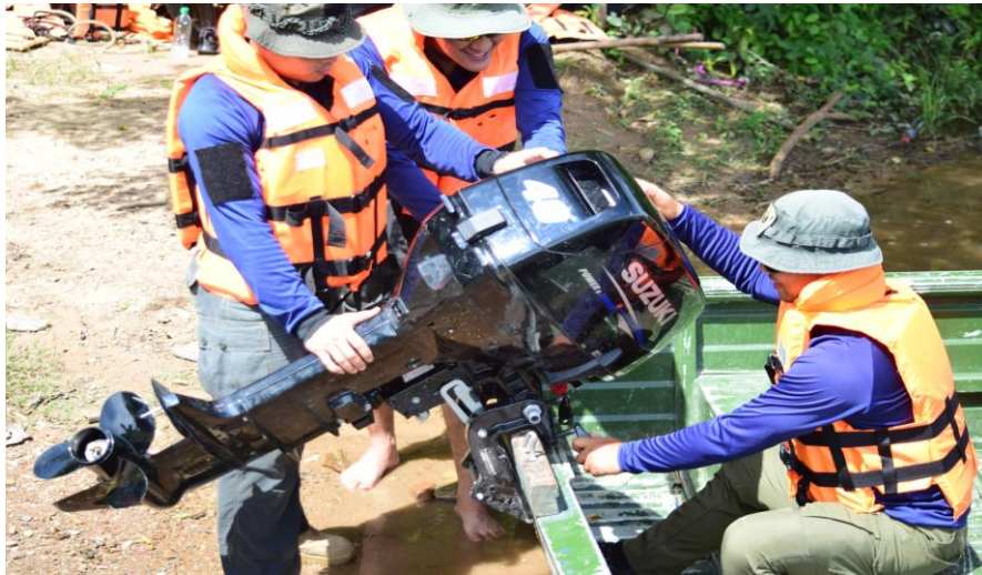
ภาพที่ ๘ ทำการขันตัวยึดแทนเครื่องยนต์เรือเข้ากับท้ายเรือทั้ง ๒ ตัวให้แน่น
