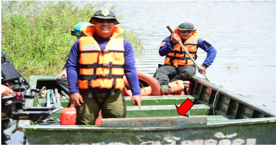
ภาพที่ ๖ แท่นเรือสำหรับวางเครื่องยนต์เรือ
