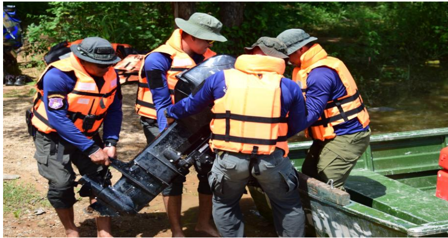
ภาพที่ ๗ นำเครื่องยนต์เรือวางบนแท่นท้ายเรือ โดยให้เครื่องยนต์อยู่กึ่งกลางของท้ายเรือ
