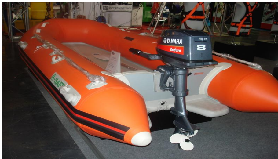
ภาพที่ ๑ ตรวจสอบรอยร้าวหรือรอยฉีกขาดของตัวเรือและห้องลอยลม (ท่อลม) ให้แน่ใจว่าอยู่ในสภาพสมบูรณ์
