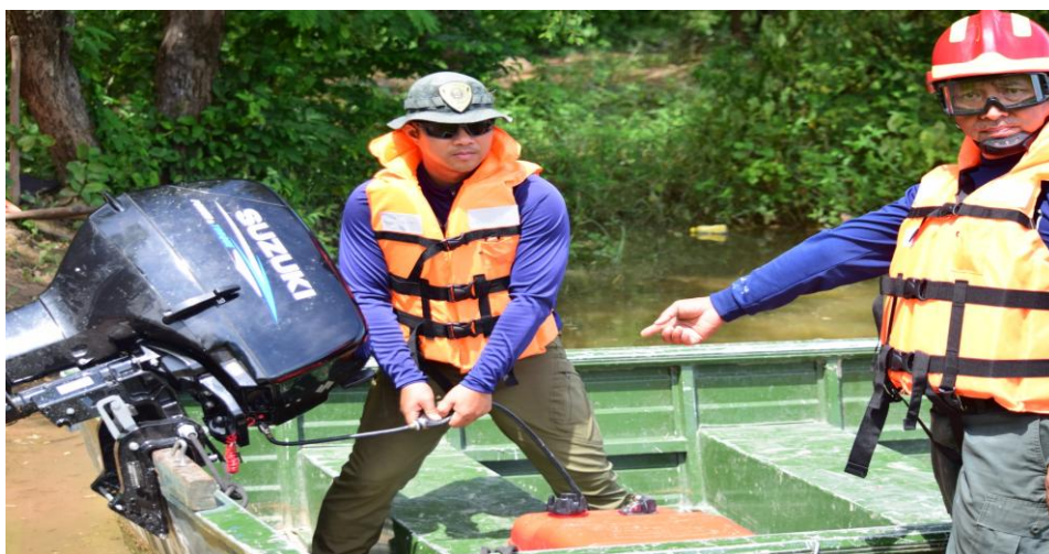
ภาพที่ ๑๑ ทำการบีบลูกยางเพื่อปั้มน้ำมันเชื้อเพลิงเข้าสู่เครื่องยนต์เรือ
