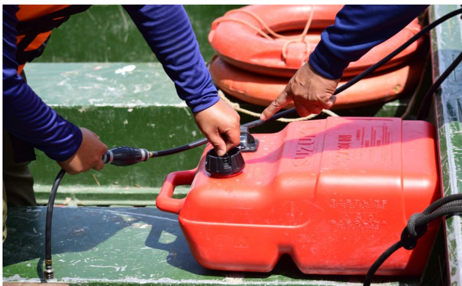
ภาพที่ ๑๐ นำถังน้ำมันเชื้อเพลิงกับสายส่งน้ำมันเชื้อเพลิงประกอบเข้ากับเครื่องยนต์เรือ
