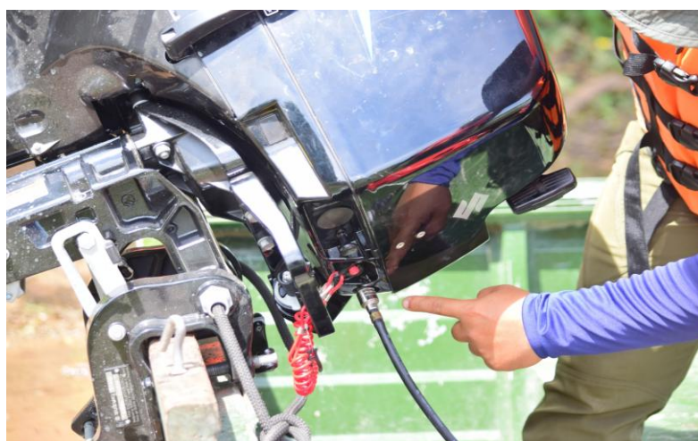
ภาพที่ ๑๒ เสียบกุญแจเข้ากับสวิทช์เปิด/ปิด บริเวณปุ่มสีแดง
