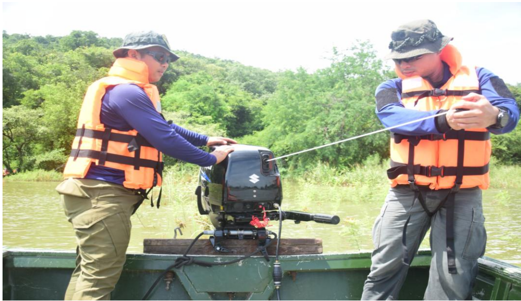
ภาพที่ ๑๓ ดึงโช๊คค้างไว้ แล้วทำการดึงสายสตาร์ท
