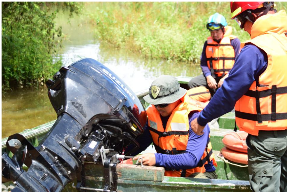
ภาพที่ ๙ นำเชือกบุคคลมาร้อยเข้ารูที่แทนเครื่องเครื่องยนต์เรือจากนั้นผูกให้แน่นนำปลายเชือกอีกด้านหนึ่งผูกเข้ากับตัวเรือเพื่อป้องกันเครื่องยนต์เรือตกน้ำ
