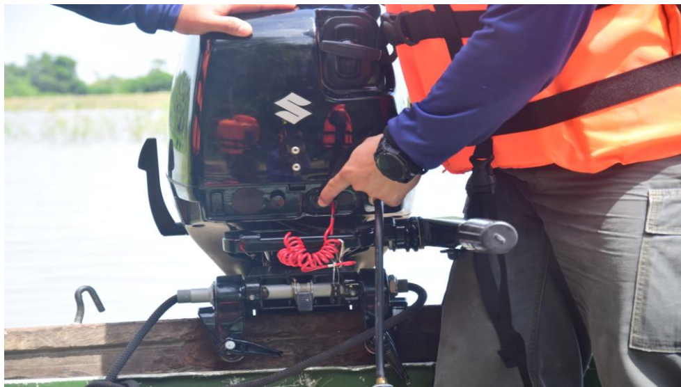
ภาพที่ ๑๔ เมื่อเครื่องยนต์เรือติดแล้วให้ทำการดันโช๊คกลับที่เดิม
