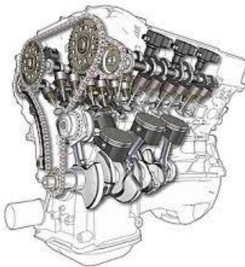
ภาพที่ ๒๙ หลักการทำงานของเครื่องยนต์
